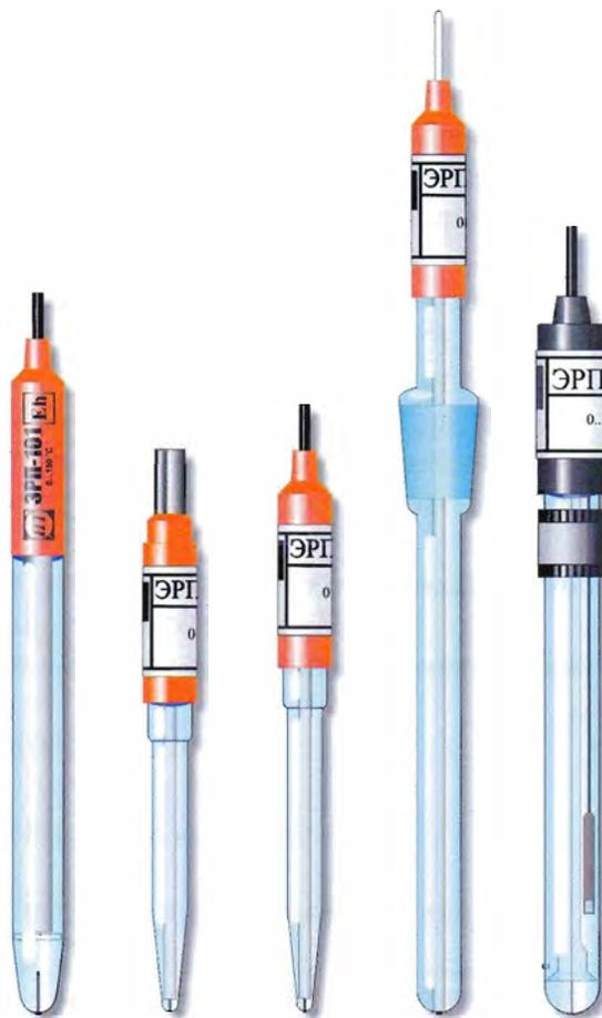
Рис.1. Фотография внешнего вида электродов редоксметрических платиновых ЭРП-1
